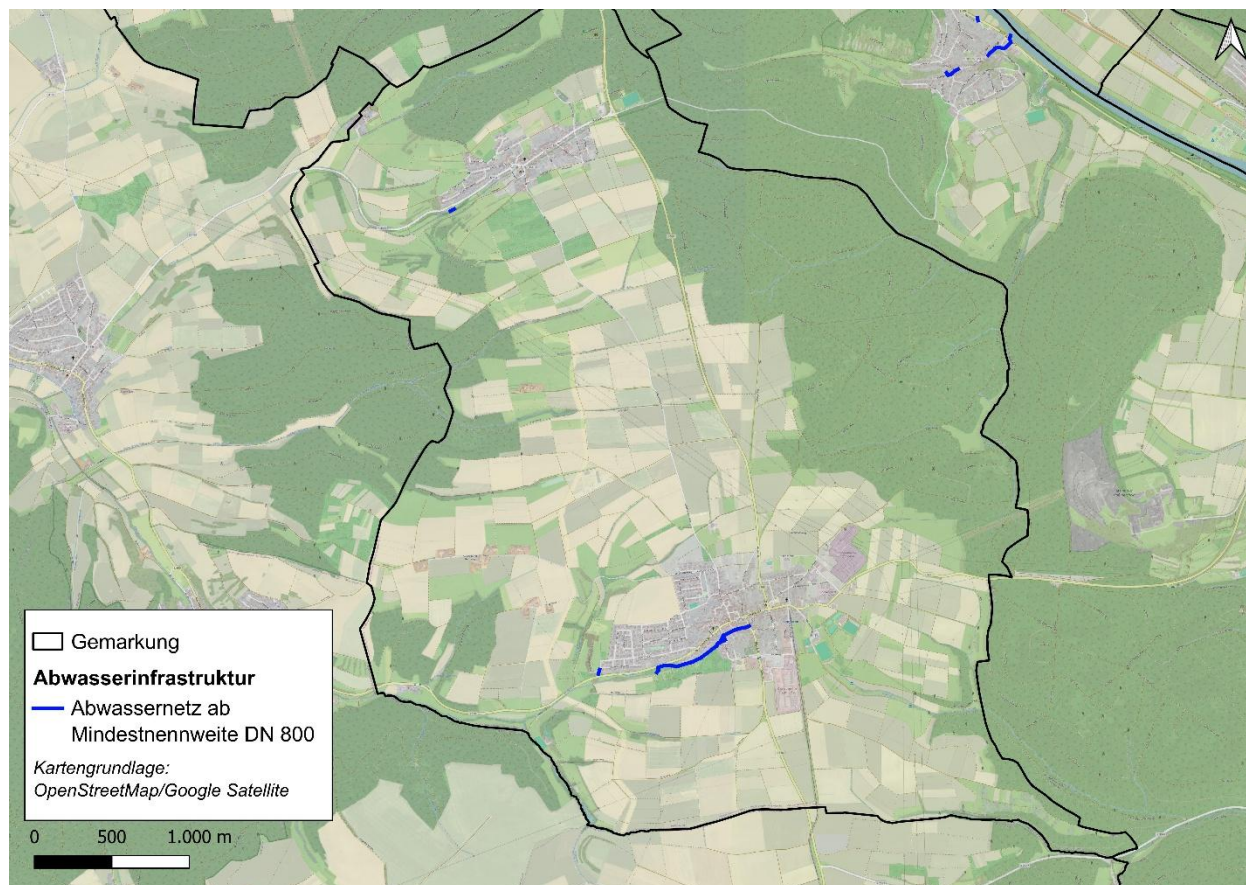
Abbildung 13: Abwassernetz der Gemarkung Hüffenhardt (Mindestnennweite DN 800)
