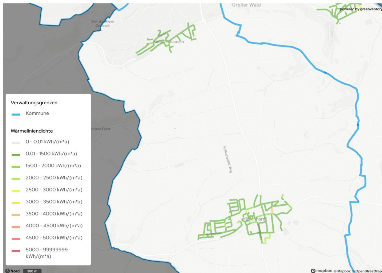
Abbildung 17: Wärmebedarf nach Straßensegmenten (Wärmeliniendichte)
